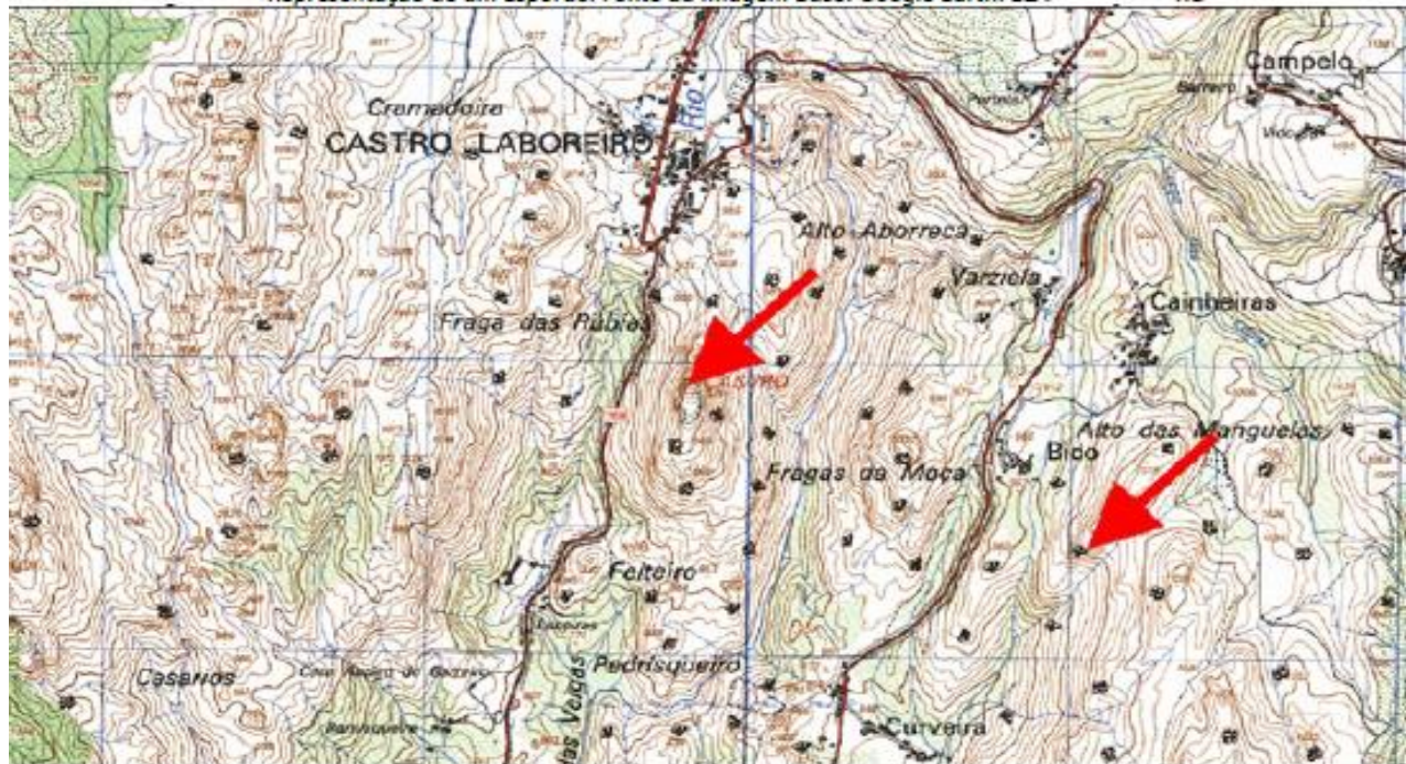
- Representação de um Esporão na Carta Topográfica. Mapa: Carta Militar do IGeoE. I
