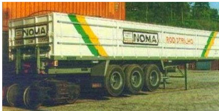
Veículo intermodal, podendo operar tanto em ferrovias como em rodovias, denominado **RODOTRILHO**, dotado de eixo e rodas ferroviárias e de eixos com pneus (*trucks*).
