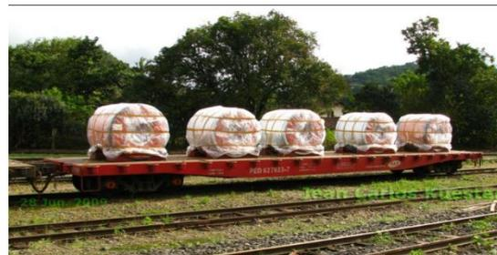
Plataforma sem paredes laterais, p/ transporte de veículos, máquinas, containers, cargas grandes e indivisíveis
