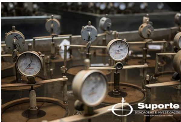
Imersão dos corpos-de-prova
