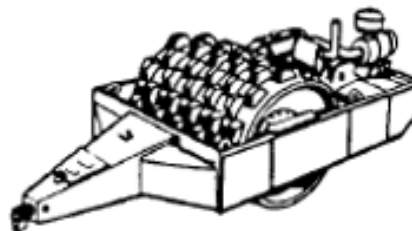
Compactador vibratório tracionado pé-de-carneiro (com patas médias).
